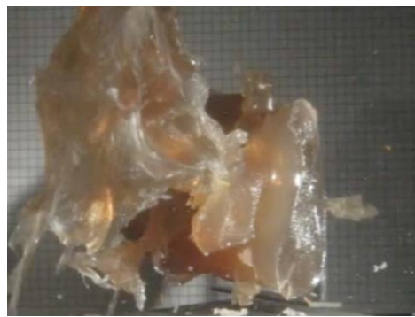
Рис. 3.5. Вигляд желатинового блоку після пострілу кулею типу «БЗТ», калібр 12,7 мм, повне розтрощення імітатору.
