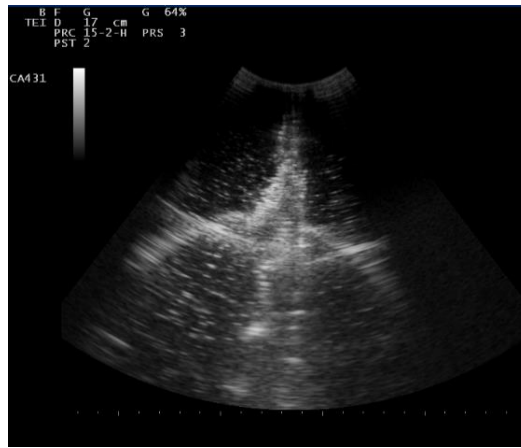
Рис. 3.7. Ультразвукове дослідження залишкових елементів тимчасової пульсуючої порожнини в блоці балістичного желатину після пострілу патроном 7,62 мм.
